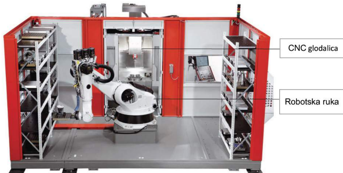
Slika 1.1.-5.: Prikaz rada robotske ruke prilikom opsluživanja CNC glodalice (Izvor; Tehnološki plan, S+B Systemtechnik d.o.o.)
