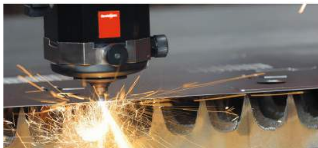
Slika 1.1.-6.: Primjer laserskog rezanja lima (Izvor: Tehnološki plan, S+B Systemtechnik d.o.o.)
